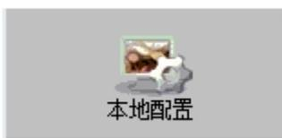
在视频监控客户端里面点击 **本地配置** 进入客户端配置界面，点击声音方案，进入声音方案配置界面；启用报警声音方案，可以为事件类型配置报警声音文件 (\*.wav) 以及报警声音结束方式，如下图。
